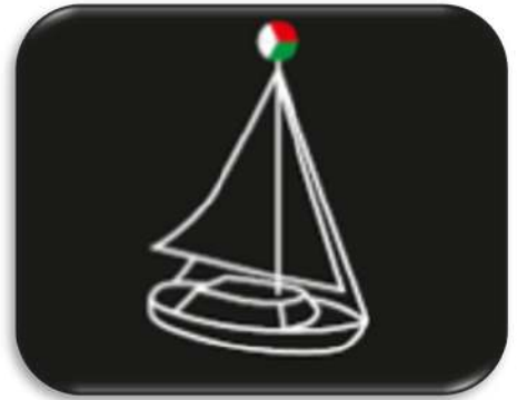
Nacht: Dreifarbenlaterne für Segelfahrzeuge in Fahrt unter 20m Länge
