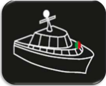
Nacht: Maschinenfahrzeug in Fahrt, mit Fahrt durch Wasser unter 12m Länge
