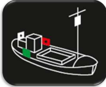
Nacht: Maschinenfahrzeug in Fahrt, mit Fahrt durchs Wasser von weniger als 50 m Länge
