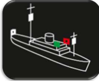
Nacht: Maschinenfahrzeug in Fahrt, mit Fahrt durchs Wasser von über 50 m Länge
