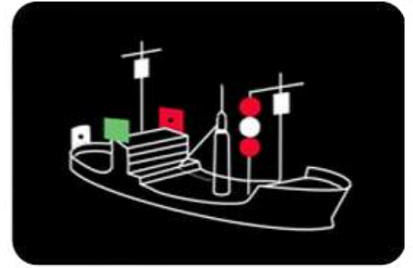
Nacht: Manövrierbehindert in Fahrt, mit Fahrt durch das Wasser (d. h. durch eigene Kraft fortbewegt) und mehr als 50 m Länge
