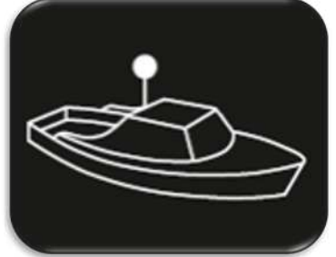
Nacht: Maschinenfahrzeug unter 7m (max. 7kn) oder Segelfahrzeuge (auch unter Ruder) unter 12m Länge; wenn andere Lichter nicht geführt werden können
