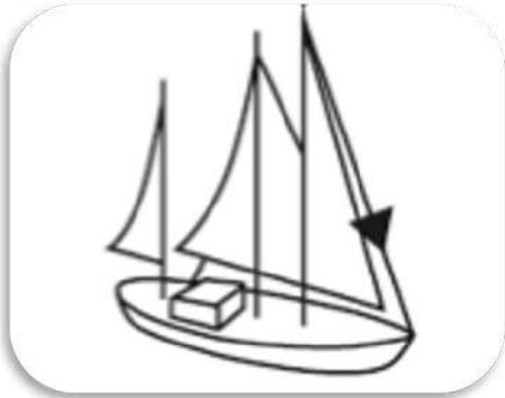
Tag: Segelfahrzeuge mit Maschinenkraft unterwegs
